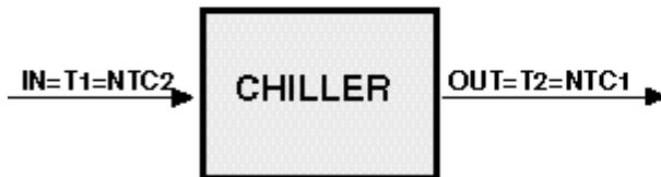
**Soluzione:** si utilizzerà un controllo a 4 uscite (IRxxZ); si sfrutteranno due uscite per la regolazione (OUT3 e OUT4), e una per la remozione dell'allarme (OUT1). L'uscita OUT2 sarà utilizzata per disattivare le uscite OUT3 e OUT4 quando  $T_2 < 8^\circ\text{C}$ . Per far ciò è sufficiente, a livello di collegamento elettrico, porre OUT2 in serie con OUT3 e OUT4, quindi rendere attiva OUT2 solo quando NTC1 ( $T_1$ ) è superiore a 8°C; (vedere schema sottostante fig. 39).
