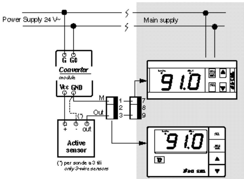
Lo schema è valido per sonde alimentabili a 24 Vdc, con segnali in tensione (IR con ingresso 0,4/1Vdc) e in corrente (IR con ingresso 0/20-4/20 mA).
