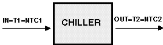
il set point, St1, dato da 'NTC1-NTC2' ovvero 'T2-T1', dovrà ora essere fissato a -5°C. Il Modo di funzionamento sarà Direct (C0=1) visto che il regolatore dovrà attivare le uscite all'aumentare del valore 'T2-T1' che da -5 tende a 0. P25=6 e P28=1 (min.) attivano l'allarme di "Bassa" richiesto, come raffigurato nel nuovo diagramma logico di regolazione (figura 19).
