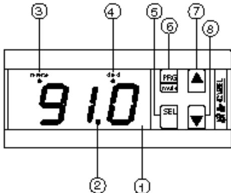
**1 – Display:** visualizza il valore della sonda collegata. In caso di allarme il valore della sonda viene visualizzato alternativamente ai codici degli allarmi attivi. Durante la programmazione mostra i codici dei parametri ed il loro valore.
